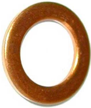
Rondella per tappi coppa. Adatto per tutte le moto BMW F650, G650, F700 e F800. L'anello ha un diametro interno di 24 mm e un diametro esterno di 30 mm.
