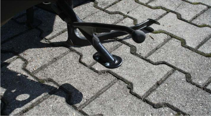
Questa estensione del cavalletto laterale garantisce alla Vostra moto una posizione verticale sicura su qualsiasi tipo di terreno, poiché la superficie di appoggio è maggiorata più del 100%. L'estensione è realizzata in alluminio di alta qualità, anodizzato nero ed è estremamente facile da montare.
